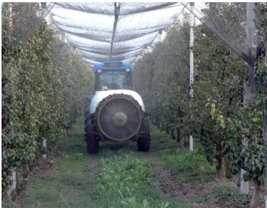
Foto 1 - Distribuzione del prodotto con atomizzatore equipaggiato con ugelli anti-deriva.
