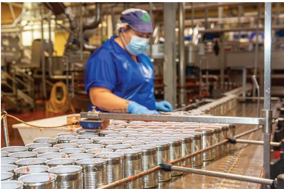
Nella foto, barattoli in latta di pomodoro in fase di riempimento in uno stabilimento di Conserve Italia. Sono confezioni che hanno conosciuto importanti aumenti di costi.
